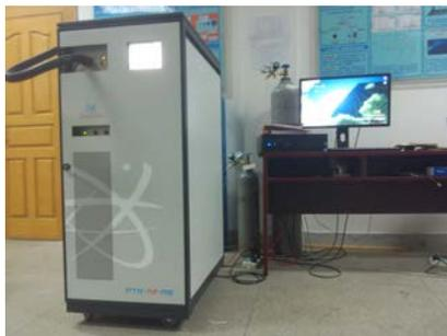
及气溶胶飞行时间质谱仪可以针对成核过程中关键尺寸（凝结核及以下尺寸）的大气团簇进行实时检测。该系统的建成，将为从分子层次研究大气气溶胶成核机理提供一条有效的途径，也将在很大程度上提高我国在大气气溶胶成核机理研究领域的研究水平。
